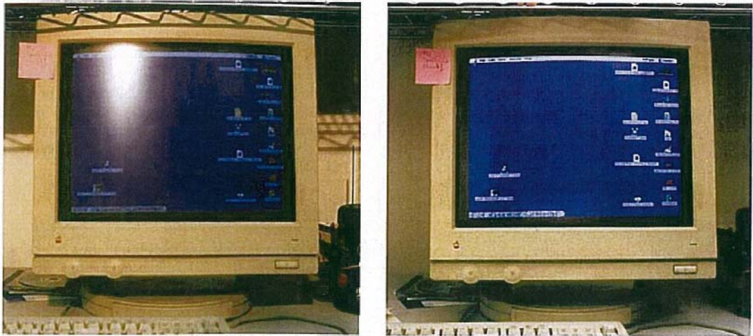
图 1.12 (a) 电气照明在 VDT 屏幕上导致的光幕反射;(b) 无光幕反射的 VDT 屏幕
