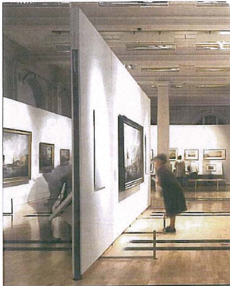
图 1.8（a）美术馆内垂直面的作业照明
